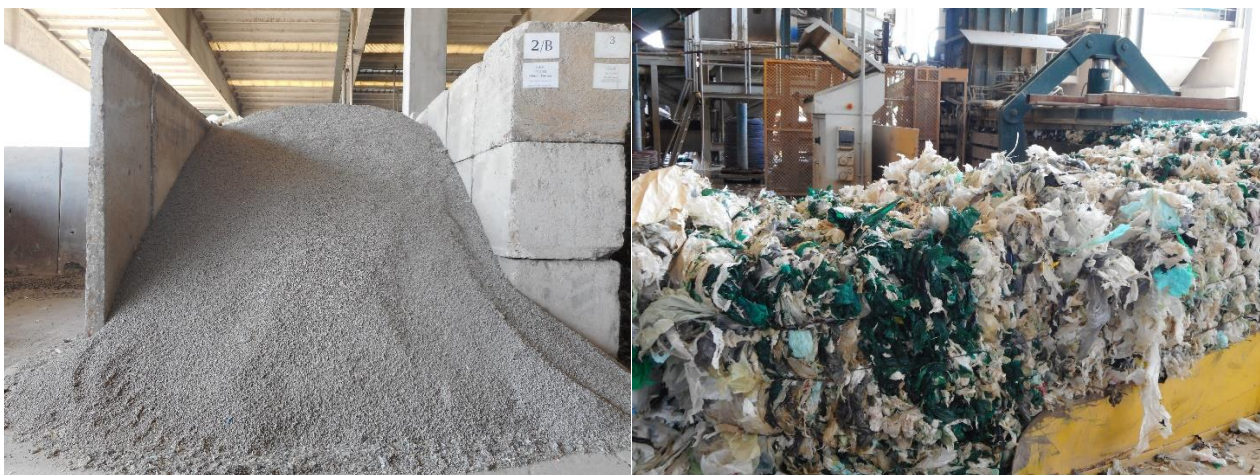
Figura 8-3 – rifiuti dell'impianto di demetallizzazione e plastica recuperata
