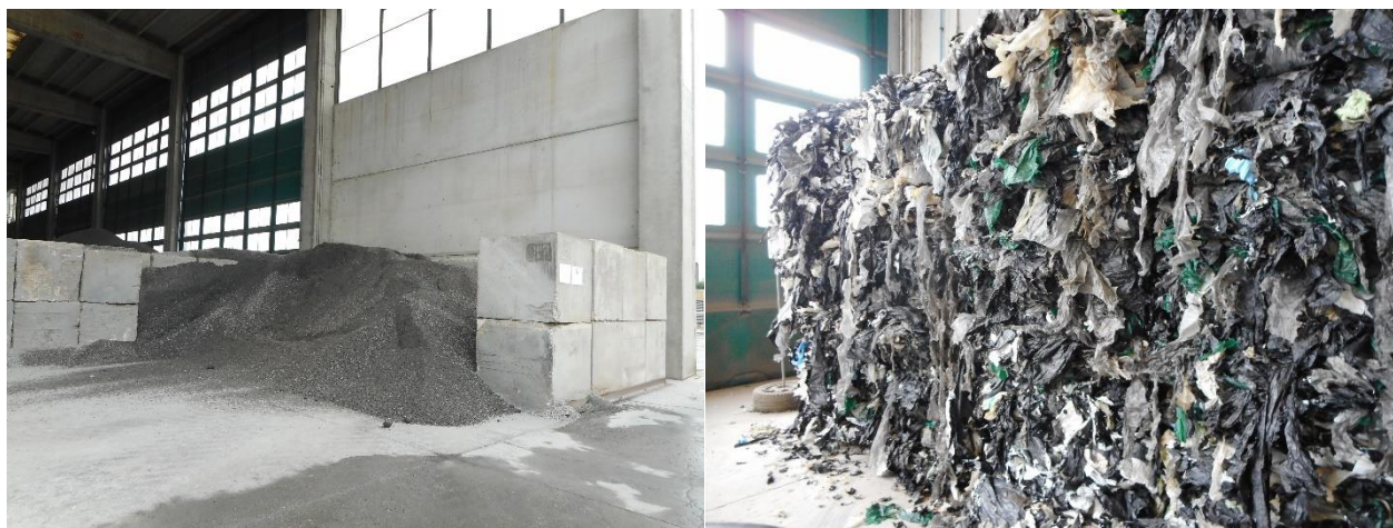
Figura 8-3 – rifiuti dell'impianto di demetallizzazione e plastica recuperata
